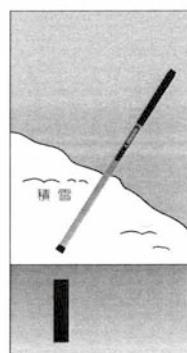
極性(N極+側・S極-側)の判別ができるので、埋没している金属物体の大きさの探測が可能です。
